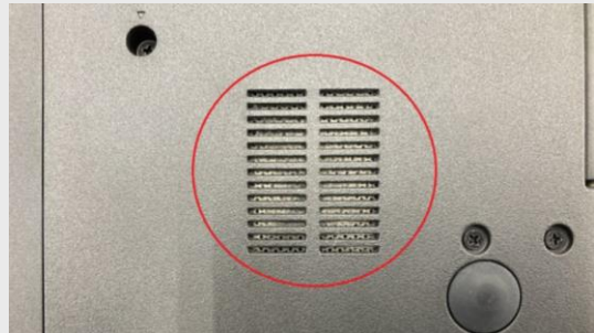
ノートパソコンの吸気口です。PCの電源を落としてから、定期的に掃除機で吸うなどして掃除しましょう。
